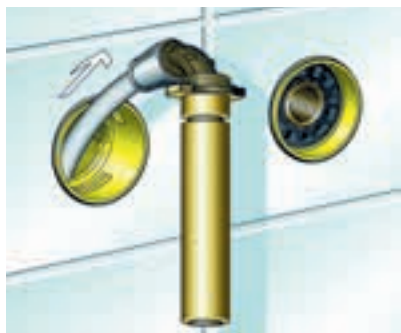
Fig. 63 – Dra ut röret med förlängning (modell 3525) ur skyddsroret
