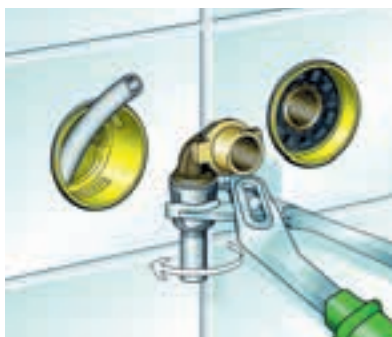
Fig. 66 – Lossa kopplingen med en tång
