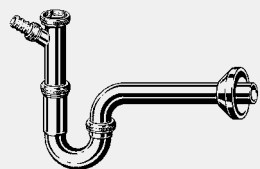
Rörvattenlås Plus siphon - förkromad mässing Tillbehör Skruvkoppling G¾, låsplatta, avsticksrör 200 mm, utloppsböj 220 mm Kvalitetskontroll enligt DIN EN 274 Modell 5611.6
