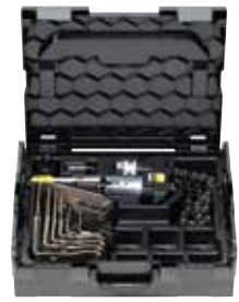
Verktogsset för inpressningsanslutningar, modell 4278.5
